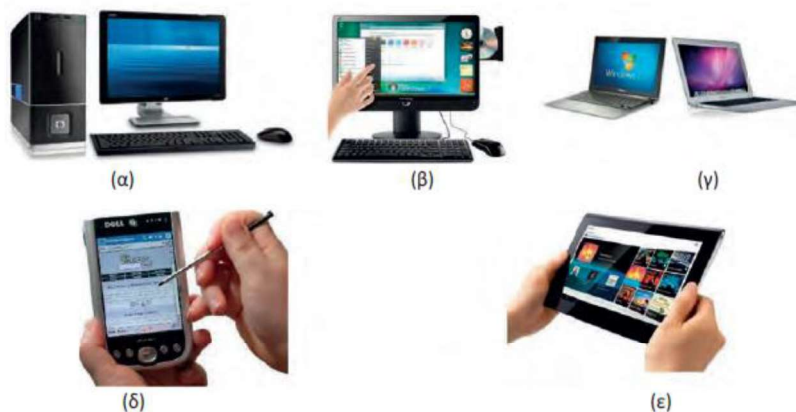
Εικόνα 2.7. (α) υπολογιστής γραφείου, (β) υπολογιστής γραφείου με ενσωματωμένη την ΚΜΕ στην οθόνη (All in One PC), (γ) φορητός υπολογιστής, (δ) παλάμης - pda και (ε) tablet
