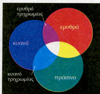
Σχήμα 6.1.2 Προσθετική μέθοδος αναπαραγωγής χρωμάτων
