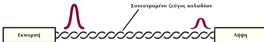
Εικόνα 2.4.1.θ: Εξασθένιση (Attenuation, Insertion Loss).
