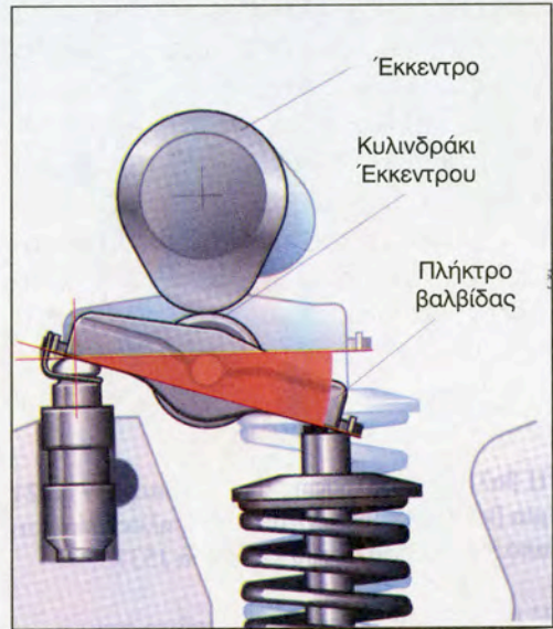
Εικόνα 2.3.4 Εκκεντροφόρος επικεφαλής, επιδρά στη βαλβίδα μέσω ζυγώθρου
