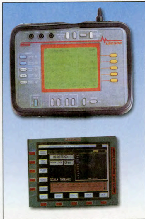
Εικόνα 5.6 Παλμογράφος αυτοδιάγνωσης και αποκωδικοποιητής - πολύμετρο
