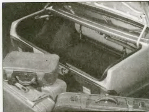
Εικόνα 7.1.4 Τοποθέτηση δοχείου αποθήκευσης στο χώρο αποσκευών.
