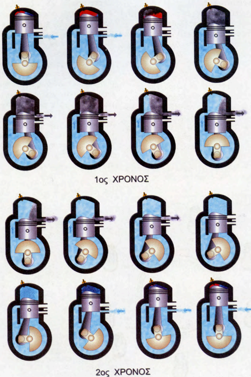
Εικόνα 1.2.12 Χρόνοι λειτουργίας και εξέλιξη των φάσεων δίχρονου βενζινοκινητήρα
