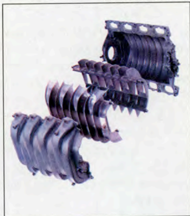
Εικόνα 2.4.6 Μεταβλητοί αυλοί εισαγωγής (Audi)
