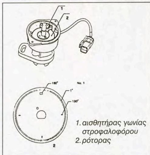
Εικόνα 3.2.16 Αισθητήρας και δίσκος με σχισμές
