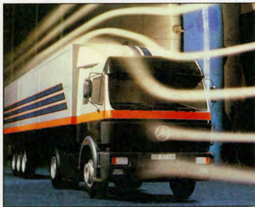
Εικόνα 8.2.2 Έλεγχος αεροδυναμικής συμπεριφοράς φορτηγού αυτοκινήτου σε αεροσύρραγμα
