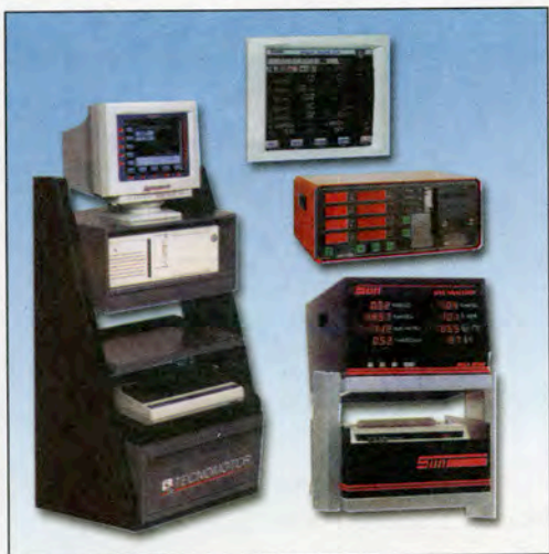
Εικόνα 5.3 Αναλυτές καυσαερίων πέντε αερίων με εκτυπωτές (κάτω)
