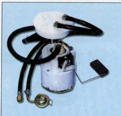
Εικόνα 3.1.10 Εμβαιπιζόμενη αντλία με δοχείο σταθεροποίησης
