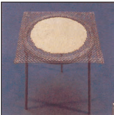
Α5 Μεταλλικό τρίποδο με πλέγμα αμιάντου
