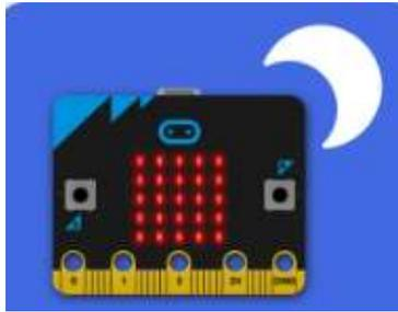
Αυτό το έργο χρησιμοποιεί τα LED του micro:bit ως είσοδο **αισθητήρα φωτός** για να δημιουργήσει ένα φως που ανάβει αυτόματα όταν πέσει το σκοτάδι. Ο αισθητήρας φωτός του micro:bit μετρά το φως σε ένα εύρος από 0 (πολύ σκοτεινό) έως 255 (πολύ φωτεινό).
