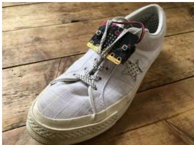
Μετατρέψτε το micro:bit σας σε μετρητή βημάτων (ή βηματόμετρο), για να σας βοηθήσει να παρακολουθείτε πόσο δραστήριοι είστε. Χρησιμοποιεί το **επιταχυνσιόμετρο** για να μετράει ένα βήμα κάθε φορά που το micro:bit ανακινείται και αποθηκεύει τον συνολικό αριθμό σε μια **μεταβλητή** που ονομάζεται βήματα.
