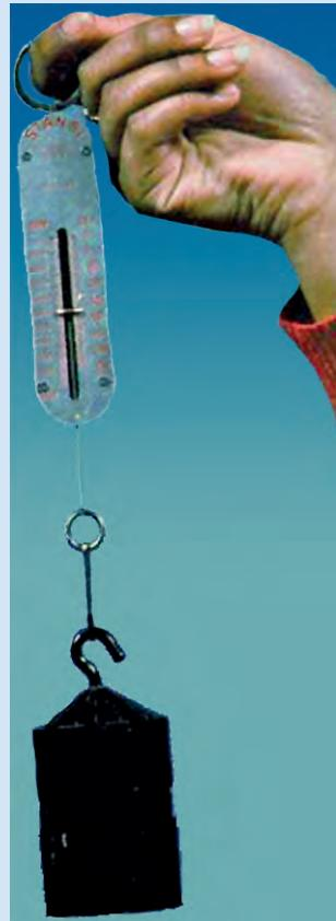
Το δυναμόμετρο είναι όργανο μέτρησης βάρους.
