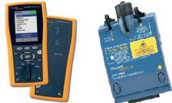
Εικ. 5.14. Όργανα πιστοποίησης δομημένης καλωδίωσης για καλώδια χαλκού και οπτικές ίνες αντίστοιχα.
