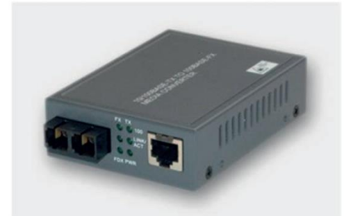
Εικ. 5.9. Media convertor RJ45 σε πολύτροπη SC οπτική ίνα.
