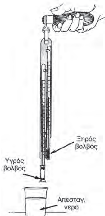
Σχήμα 10.1 Η διάταξη θερμομέτρων ξηρού και υγρού βολβού
