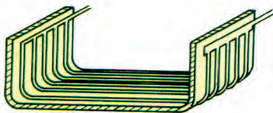
Σχήμα 6.2 Ατμοποιητής από πρεσαρισμένα ελάσματα (πλάκες)
