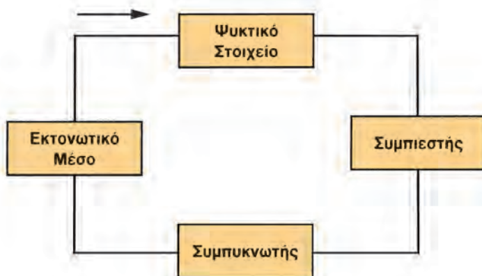
Σχήμα 5.1 Τα κύρια μέρη του ψυκτικού κύκλου
