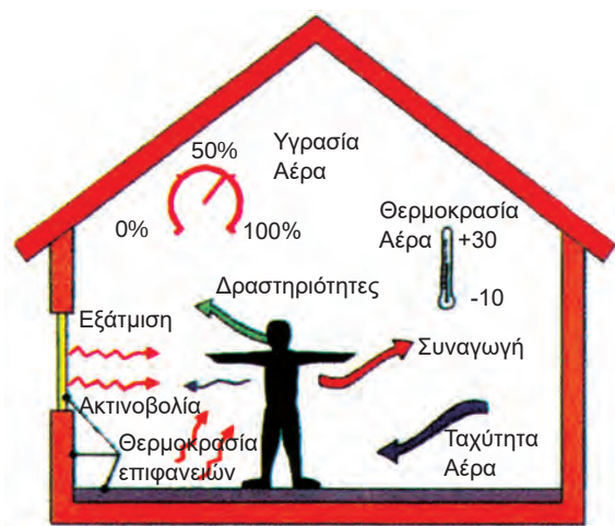
Σχήμα 9.1 Παράμετροι που καθορίζουν τις συνθήκες θερμικής άνεσης
