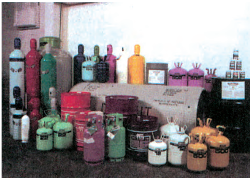
Εικόνα 6.21 Κύλινδροι αποθήκευσης ψυκτικών μέσων
