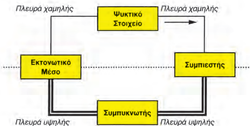
Σχήμα 5.2 Πλευρά υψηλής πίεσης και πλευρά χαμηλής πίεσης στον ψυκτικό κύκλο
