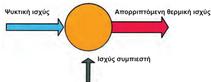
Σχήμα 5.5 Ενεργειακός ισολογισμός σε ψυκτικό κύκλο
