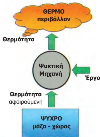
Σχήμα 1.5. Η αρχή λειτουργίας των ψυκτικών διατάξεων
