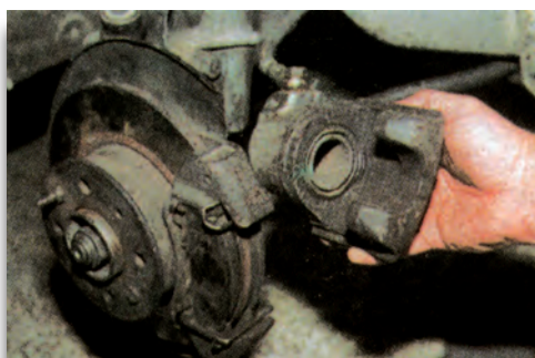
Σχήμα 4: Αφαίρεση της βάσης της δαγκάνας.
