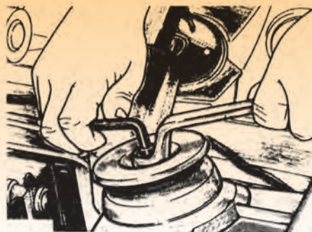
Σχήμα 2: «Λασκάρισμα» του περικοχλίου ασφαλείας του βάρου του εμβόλου.
