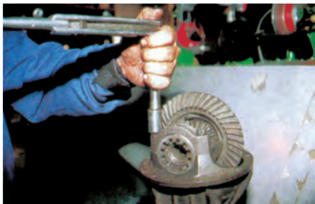
Τοποθέτηση του συγκροτήματος θήκης - κορώνας και σφίξιμο των καβαλέτων
