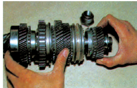
Αφαίρεση των γραναζιών και των «συγχρονιζέ»
