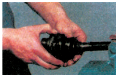
Σχήμα 7: Διαδικασία αποσυναρμολόγησης του συνδέσμου.
