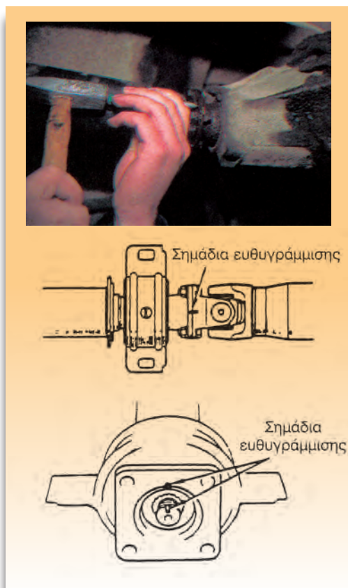
Σχήμα 1: Σημεία ευθυγράμμισης των φланτζών κεντρικού άξονα και διαφορικού.
