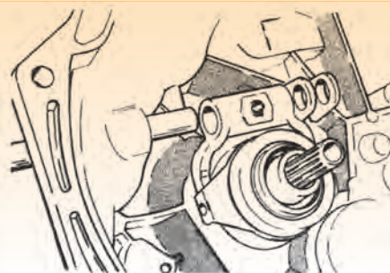
Σχήμα 2: Αφαίρεση του ρουλεμάν του συμπλέκτη καθώς και του άξονα συγκράτησής του.
