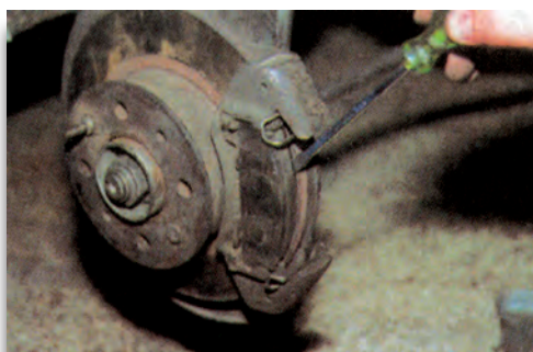
Σχήμα 5: Αφαίρεση της δαγκάνας.
