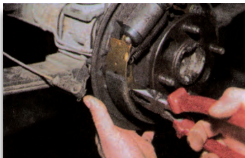
Σχήμα 4: Αφαίρεση ελατηρίου του πείρου στερέωσης.
