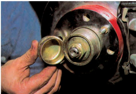
Σχήμα 2: Αφαίρεση προστατευτικού καπακιού και λασκάρισμα του κεντρικού περικοχλίου.
