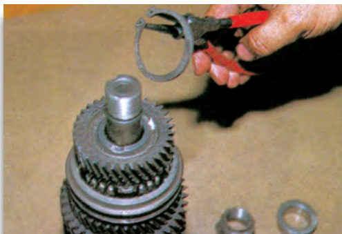
Σχήμα 1: Αφαίρεση της ασφάλειας του άξονα.
