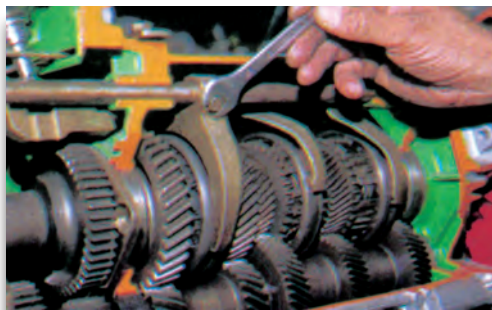
Σχήμα 16: Αφαίρεση των κοχλιών συγκράτησης των διχάλων.
