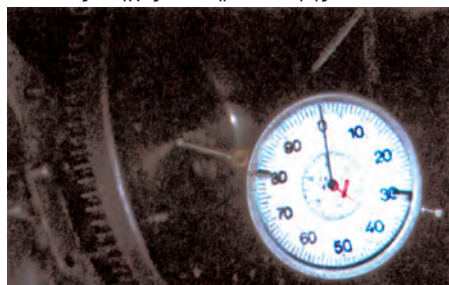
Έλεγχος παραμόρφωσης της επιφάνειας επαφής
