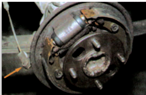
Σχήμα 5: Αποσύνδεση του μηχανισμού του χειρόφρενου.
