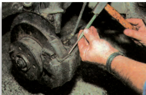
Σχήμα 4: Αφαίρεση της βάσης της δαγκάνας.
