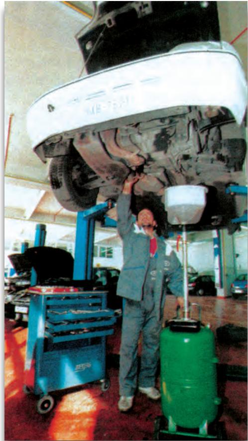
Σχήμα 1: Αντικατάσταση λιπαντικού κιβωτίου ταχυτήτων.
