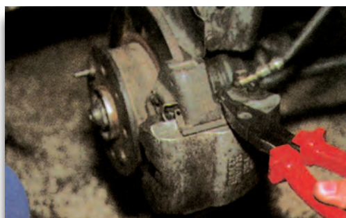
Σχήμα 3: Αφαίρεση των ασφαλειών των βάσεων της δαγκάνας.
