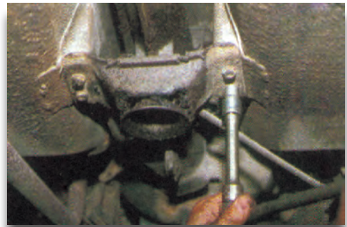
Σχήμα 7: Αφαίρεση ελαστικής βάσης.
