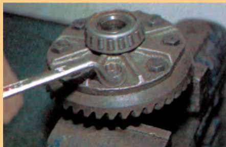
Σχήμα 4: Λύσιμο και αφαίρεση καβαλέτων και ρουλεμάν.
