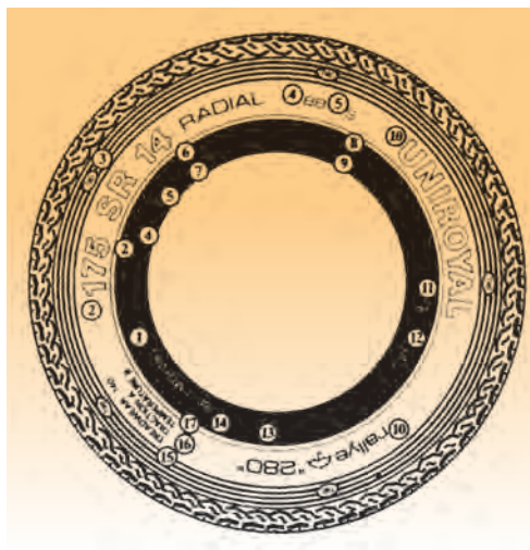
Σχήμα 1: Χαρακτηριστικά των ελαστικών που αναγράφονται επί του ελαστικού.
