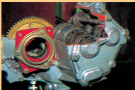
α. Συγκρότημα κιβωτίου ταχυτήτων και διαφορικού εμπροσθοκίνητου οχήματος
