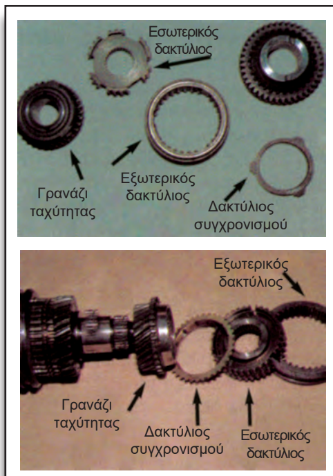
Σχήμα 3: Αποσυναρμολογημένος μηχανισμός συγχρονισμού.
