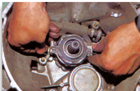
Σχήμα 13: Αφαίρεση των ασφαλειών και του ρουλεμάν του συμπλέκτη.
