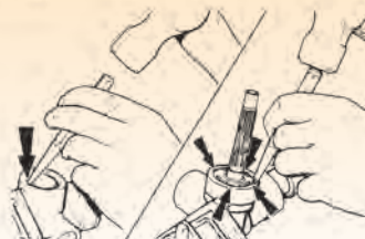
Ξεβίδωμα του ασφαλιστικού παξιμαδιού του άξονα διεύθυνσης
