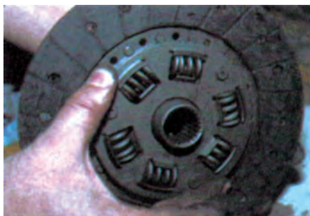
Έλεγχος ανοχών των ελασμάτων
