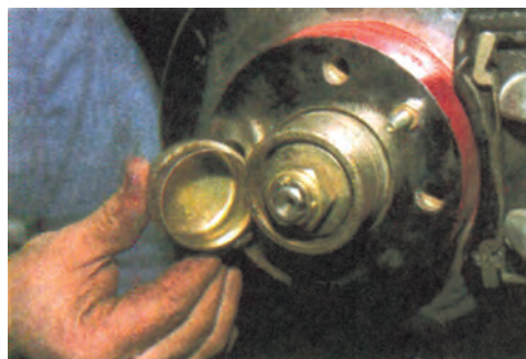
Σχήμα 9: Αφαίρεση του καλύμματος και του κεντρικού περικοχλίου του ημιαξονίου.
