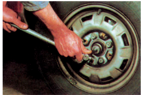
Σχήμα 2: Αφαίρεση προστατευτικού καπακιού και λασκάρισμα του κεντρικού περικοχλίου.
