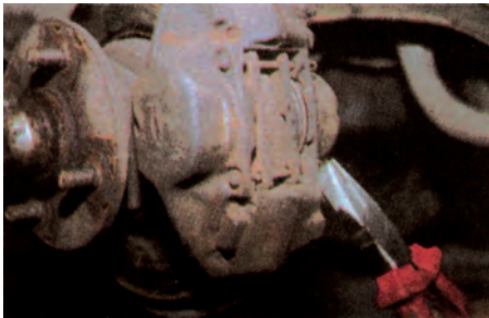
Σχήμα 7: Αφαίρεση των ασφαλειών των πείρων - οδηγών.
