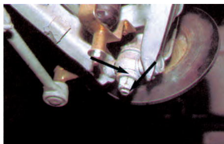
Σχήμα 3: Αφαίρεση σφαιρικού συνδέσμου από το ψαλίδι.
