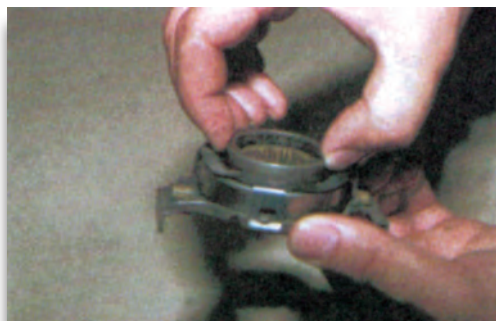
Σχήμα 8: Έλεγχος του ρουλεμάν πίεσης.
