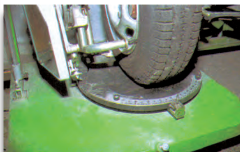
Σχήμα 7: Τοποθέτηση οχήματος στη συσκευή ευθυγράμμισης.
