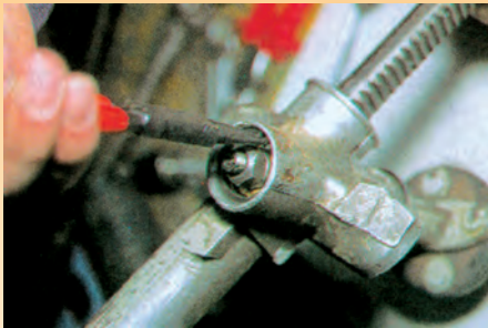
Απασφάλιση και αποσύνδεση του άξονα του πινιόν
