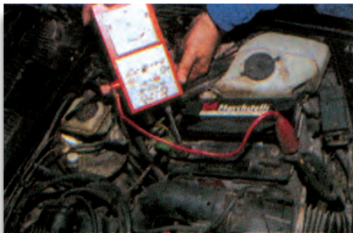
Σχήμα 6: Έλεγχος συσσωρευτή με βολτόμετρο ταχείας εκφόρτισης.
