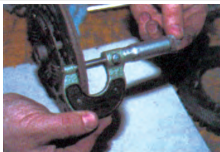
Μέτρηση πάχους του υλικού τριβής
