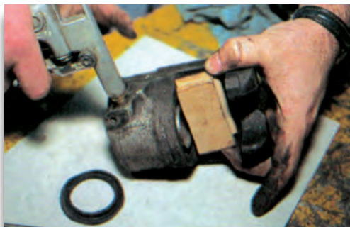
Σχήμα 11: Αφαίρεση εμβόλου δαγκάνας.
