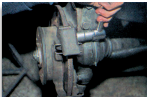
Σχήμα 12: Αφαίρεση του στηρίγματος του δισκόφρενου.
