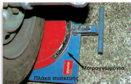
Σχήμα 2: Πλάκα και μοιρογνωμόνιο ευθυγράμμισης.
