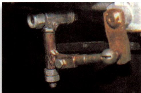
Σχήμα 3: Αποσύνδεση του μηχανισμού αλλαγής ταχυτήτων.
