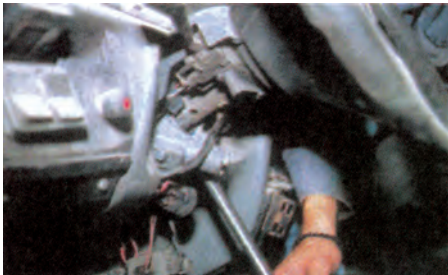
Αφαίρεση της βάσης του άξονα του τιμονιού
