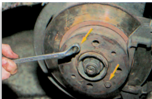
Σχήμα 13: Αφαίρεση δίσκου (δισκόπλακας).
