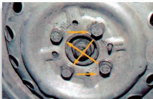
Σχήμα 2: Διαδικασία αφαίρεσης του τροχού.
