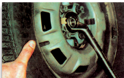
Σχήμα 3: Λασκάρισμα του κεντρικού παξιμαδιού.
