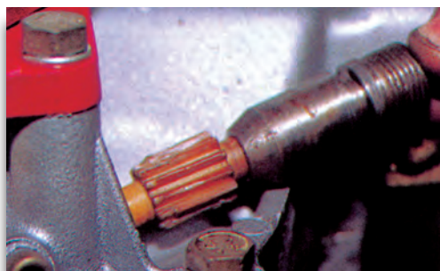
Σχήμα 19: Αφαίρεση του γραναζιού του χιλιομετρητή.
