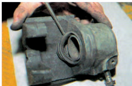
Σχήμα 10: Αποσύνδεση του σωλήνα και αφαίρεση προστατευτικού καλύμματος εμβόλου.
