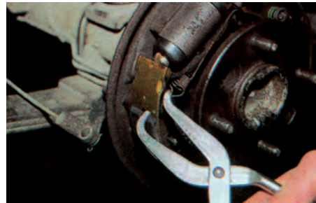
Σχήμα 3: Αφαίρεση επανατατικών ελατηρίων. ρόβιδες) και αφαιρέστε τις, (Σχήμα 2).
