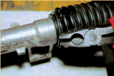
Αφαίρεση του σφικτήρα από την ελαστική φουσούνα
