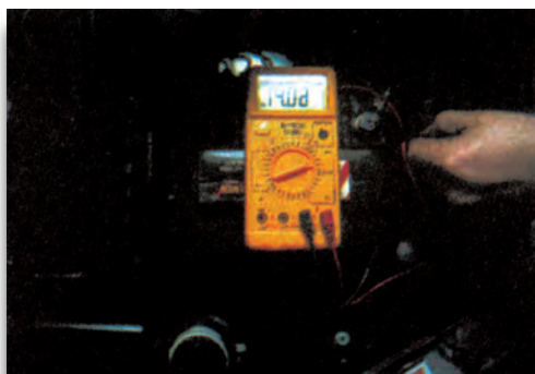
Σχήμα 2: Έλεγχος της τάσης φόρτισης του εναλλακτήρα με πολύμετρο.
