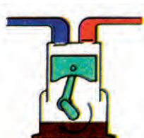
Σχήμα 4.1.3 Ερμητικός συμπιεστής Βαλβίδες αναρρόφησης και κατάθλιψης
