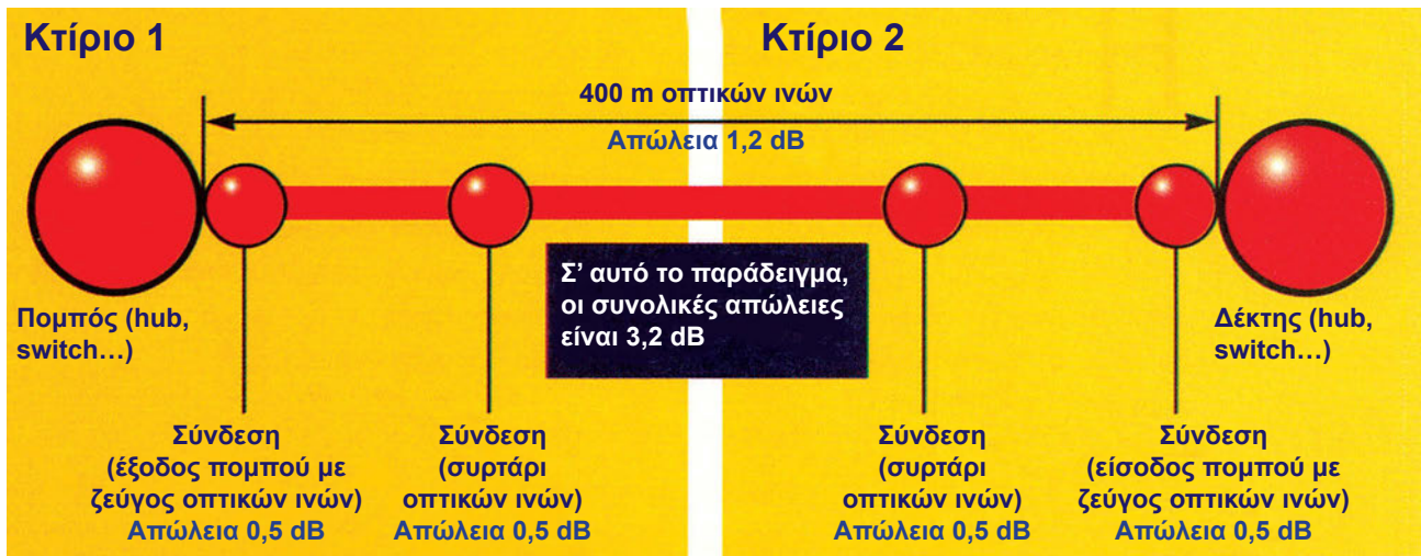
Σχήμα 3.16: Απώλειες οπτικών ινών.
