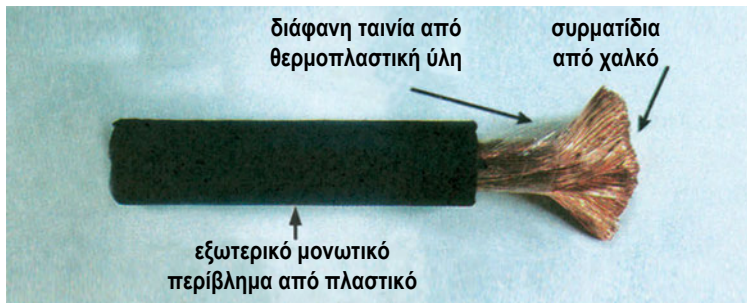
Φωτογραφία 6.3.2.γ Εύκαμπτο καλώδιο ηλεκτροσυγκολήσεων
