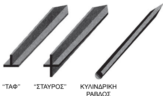
Σχήμα 7.4.3.γ Ραβδοειδή ηλεκτρόδια διαφόρων μορφών
