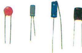
Πυκνωτές ηλεκτρονικών κυκλωμάτων
