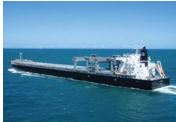
Σχ. 20.1 Γερανογέφυρα πλοίου.
