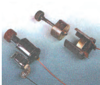
Εικ. 5.5 Δυναμό (εσωτερικό).
