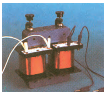
Εικ. 5.10 Μετασχηματιστής. Η λειτουργία του στηρίζεται στο Φαινόμενο της αμοιβαίας επαγωγής. Η τάση που εφαρμόζεται στο ένα πηνίο μετασχηματίζεται σε μια άλλη τάση διαφορετικού πλάτους στο δεύτερο πηνίο.
