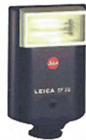
Εικ. 3.7 Η λειτουργία του φλας της φωτογραφικής μηχανής στηρίζεται στην εκφόρτιση ενός πυκνωτή δια μέσου μιας λυχνίας ξένο. Καθώς εκφορτίζεται ο πυκνωτής το αέριο ξένο ιονίζεται με αποτέλεσμα την έντονη αναλαμπή μικρής διάρκειας.
