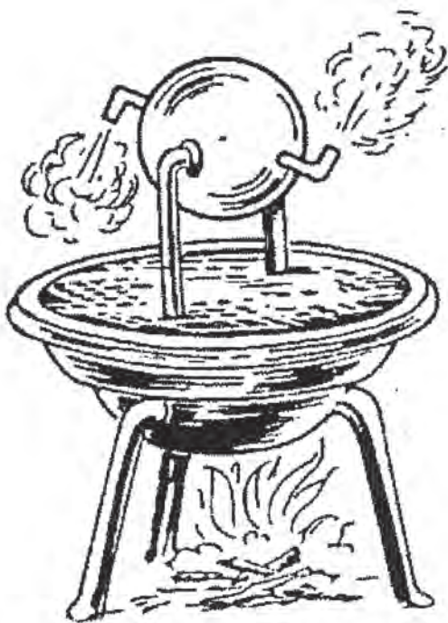
Εικ. 2.1 Σχέδιο του ατμοστρόβιλου που επινόησε ο αρχαίος Έλληνας εφευρέτης Ήρων (Αλεξάνδρεια, περ. 100 μ.Χ.). Το δοχείο είναι κλειστό και επικοινωνεί με τη σφαίρα με τους δύο κατακόρυφους σωλήνες. Με βρασμό νερού παράγεται ατμός στο δοχείο που εισέρχεται από τους σωλήνες στη σφαίρα και εξέρχεται με μεγάλη ταχύτητα από τα δύο ακροφύσια θέτοντας σε περιστροφή τη σφαίρα.
