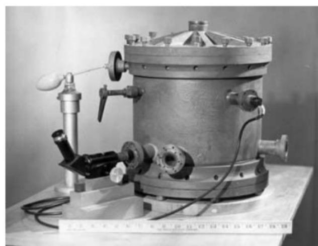
τοποθετημένους οριζόντια). Αρνητικά φορτισμένες σταγόνες λαδιού εισέρχονται από την οπή A που υπάρχει στο θετικό οπλισμό του οριζόντια επίπεδου πυκνωτή. Όλο τα σύστημα βρίσκεται σε κενό. Η σταγόνα  $\Sigma$ , με μάζα  $m = 0,1 \text{ g}$  και φορτίο  $q = 1,5 \times 10^{-8} \text{ C}$ , κινείται ήδη εντός του ομογενούς ηλεκτρικού πεδίου του πυκνωτή, που έχει ένταση  $E = 60 \text{ kV/m}$ . Η απόσταση μεταξύ των οπλισμών του πυκνωτή είναι  $d = 10 \text{ mm}$ .
