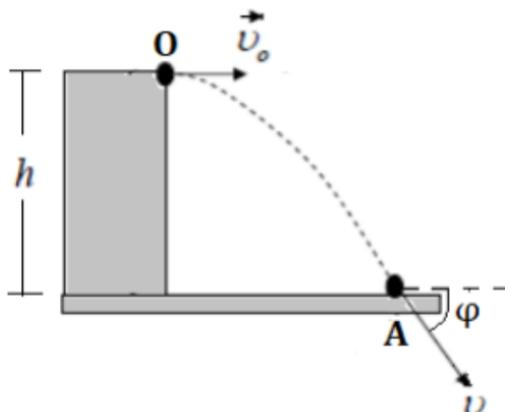
Σφαίρα μάζας  $m = 0,1\text{Kg}$  βάλλεται οριζόντια με ταχύτητα μέτρου  $v_0 = 20\text{m/s}$  από την ταράτσα ενός κτιρίου ύψους  $h$  από το έδαφος. Όταν πέφτει στο έδαφος η σφαίρα η ταχύτητά της σχηματίζει με αυτό γωνία  $\varphi = 45^\circ$  (όπως φαίνεται στο παραπάνω σχήμα).
