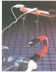
Εικ. 4.11 Όταν ο αγωγός που βρίσκεται ανάμεσα στους πόλους του μαγνήτη διαρρέεται από ρεύμα εκτρέπεται από τη θέση ισορροπίας του. Η εκτροπή του είναι αποτέλεσμα της δύναμης που δέχεται από το μαγνητικό πεδίο.
