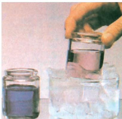
ΣΧΗΜΑ 4.5 Η εξώθερμη ισορροπία, που γίνεται σε υδατικό διάλυμα: \text{CoCl}_4^{2-} + 6\text{H}_2\text{O} \rightleftharpoons \text{Co}(\text{H}_2\text{O})_6^{2+} + 4\text{Cl}^- \quad \Delta H < 0 (μπλε) (ροδόχρωμο)
