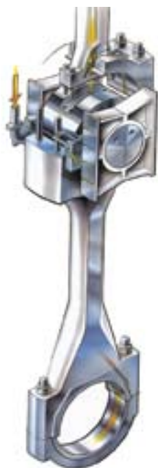
Σχ. 5.8γ Διωστήρας δίχρονης αργό- στροφης πετρελαιομηχανής συνδεδεμένος με το ζύγωμα.
