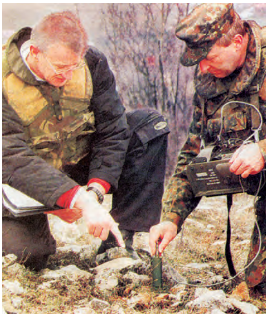
Εικόνα 2.47: Η ραδιενεργός ρύπανση ελέγχεται με ειδικούς μετρητές.
