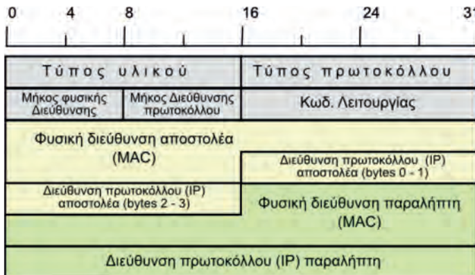
Εικόνα 3.3.β: Δομή πακέτου ARP
