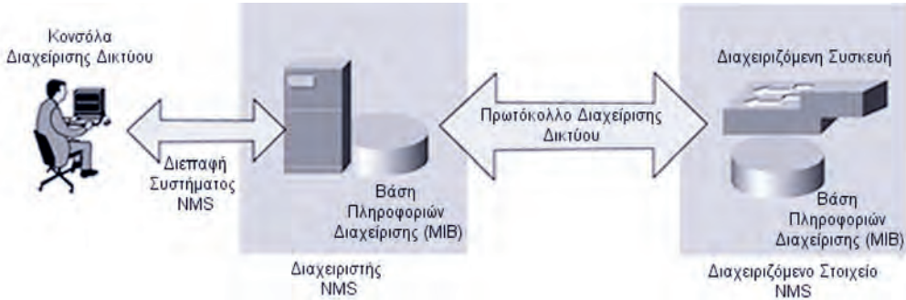
Εικόνα 7.1.α: Βασική δομή Συστήματος Διαχείρισης Δικτυού (NMS)
