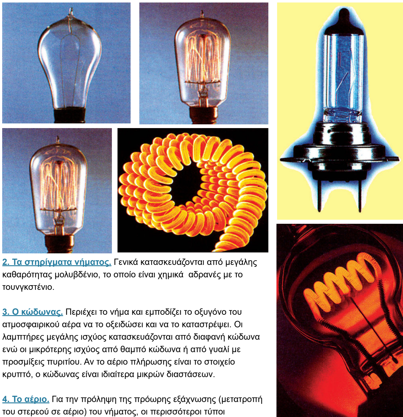
Σχήμα 3.2: Διάφορες μορφές νημάτων λαμπτήρων πυράκτωσης
