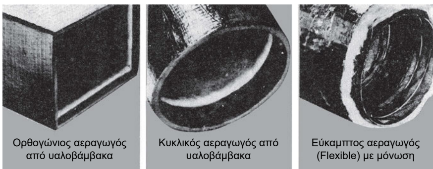
Εικόνα 12.4. Διατομές αεραγωγών από υαλοβάμβακα
