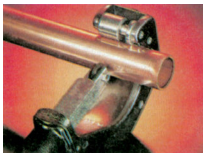
Εικόνα 6.2 Εργαλείο κοπής σωλήνων (σκληροκόπτης). Στην εικόνα δεξιά, σκληροκόπτης σε χρήση
