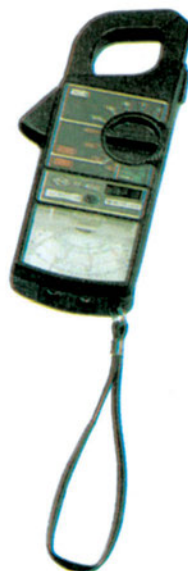
Εικόνα 6.4 Αμπερόμετρο τύπου «τσιμπίδα»
