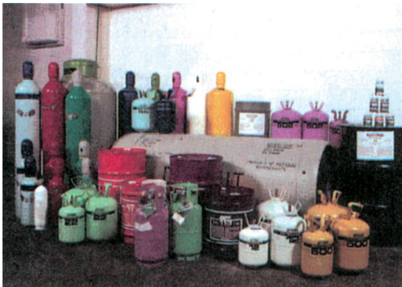
Εικόνα 6.21 Κύλινδροι αποθήκευσης ψυκτικών μέσων
