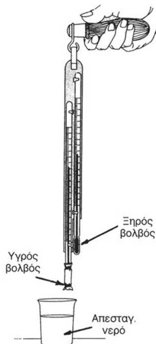
Σχήμα 10.1 Η διάταξη θερμομέτρων ξηρού και υγρού βολβού
