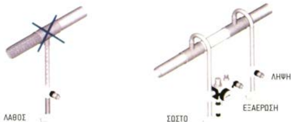
Σχήμα 14.2: Τρόπος λήψης παροχών από σωλήνες δικτύου αέρος
