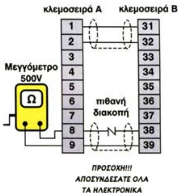
Σχήμα 24.15(β): Ανίχνευση πιθανής διακοπής με μεγγέρομετρο
