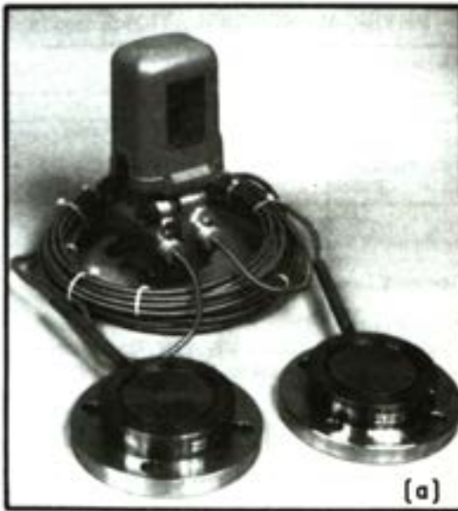
Σχήμα 22.2: α) Απόλυτα και β) διαφορικά σταθμίμετρα τύπου χωρητικότητας και διακόπτης στάθμης με πλωτήρα (φλοτέρ)
