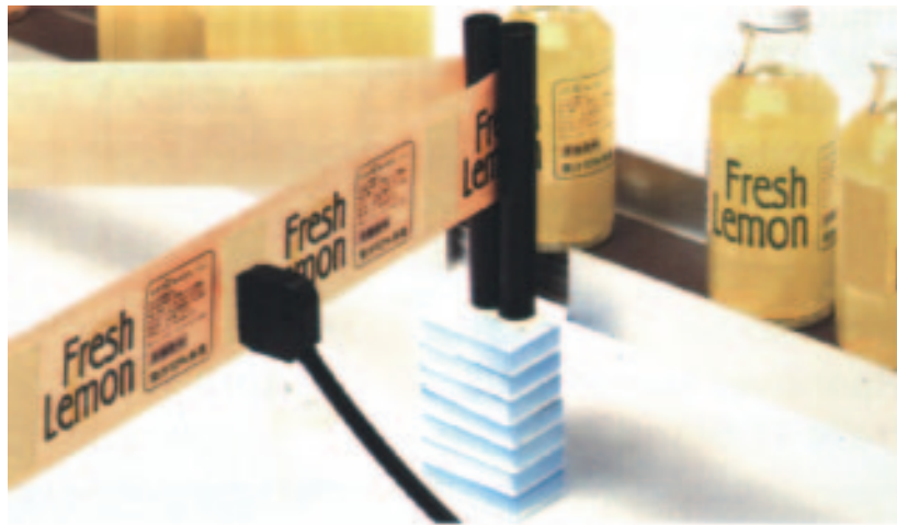
Σχήμα 5.32: Φωτοκύτταρα με ανίχνευση της αντίθεσης χρώματος.
