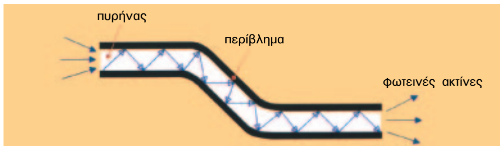
Σχήμα 5.35: Οδήγηση φωτεινής ακτίνας μέσα σε καλώδιο οπτικής ίνας.
