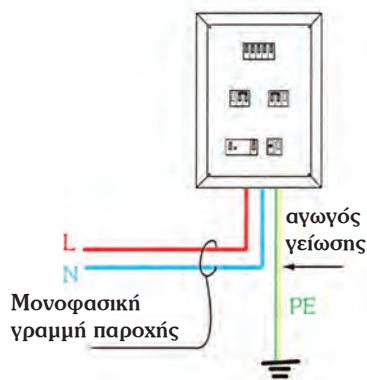
Σχήμα 2.9.2ε: Μονοφασικός πίνακας
