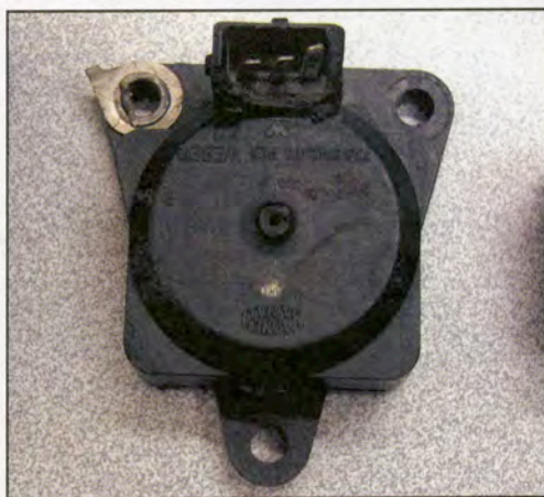
Σχήμα 19: Αισθητήρας απόλυτης πίεσης (υποπίεσης) του εισερχομένου αέρα στην πολλαπλή εισαγωγή.
