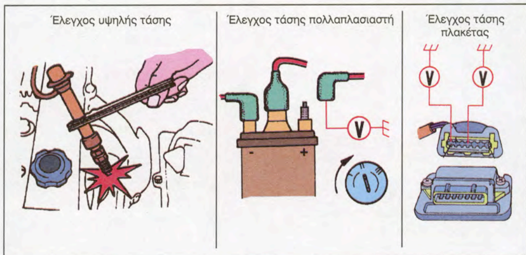
Σχήμα 18: Έλεγχοι εξαρτημάτων ηλεκτρονικής ανάφλεξης.
