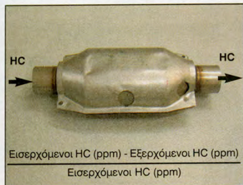
Σχήμα 14: Υπολογισμός του βαθμού απόδοσης ενός καταλύτη.
