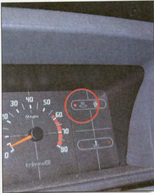
Σχήμα 13: Το άναμμα της προειδοποιητικής λυχνίας με την ένδειξη CHECK ENGINE δείχνει ότι μια βλάβη έχει καταγραφεί στη μνήμη KAM.
