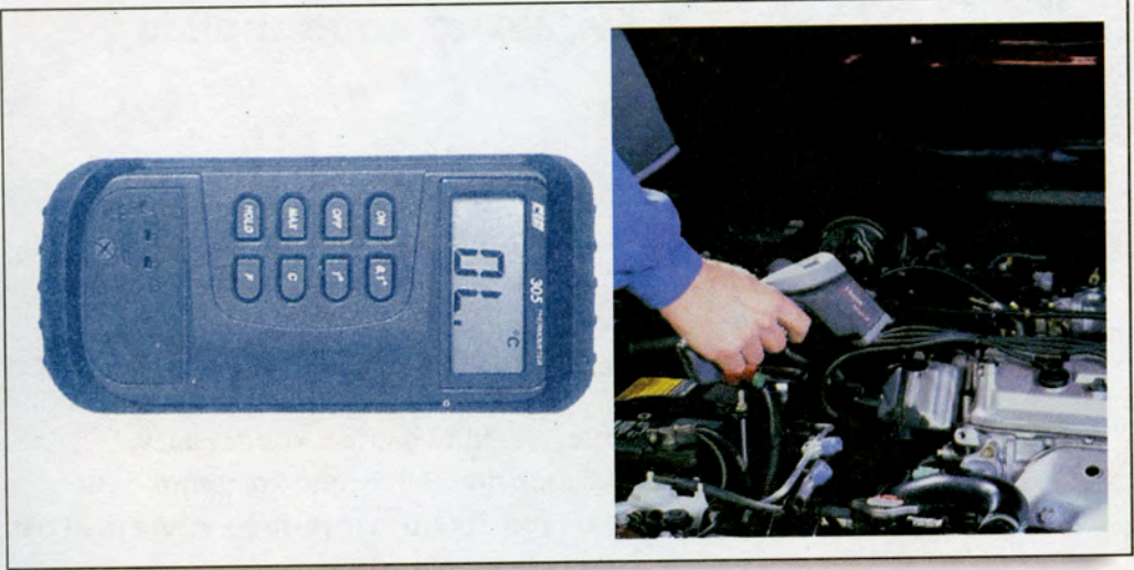
Σχήμα 12: Ψηφιακό θερμόμετρο και θερμόμετρα υπερύθρων ακτίνων.
