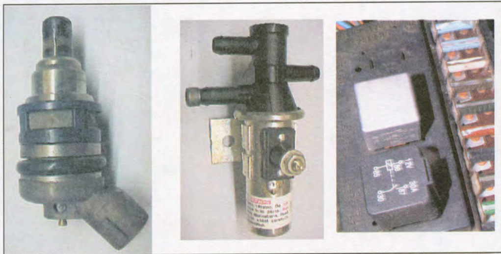
Σχήμα 3: Ηλεκτρομαγνητικές βαλβίδες και κιβώτιο ηλεκτρονόμων.
