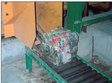
Εικ. 7.9 Διαχωρισμός αλουμινίου σε εργοστάσιο μηχανικής διαλογής
