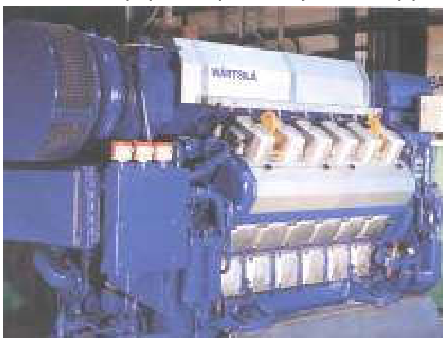
Φινλανδικός κινητήρας Diesel Wartsila 12 κύλινδροι σε διάταξη V. Εσωτερική διάμετρος κυλίνδρου: 200 mm. Διαδρομή εμβόλου: 240 mm.
