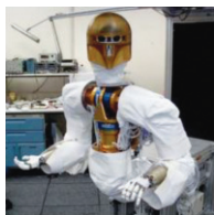
Εικόνα 3.26. Ο «ρομποναύτης» της NASA κατασκευάστηκε για την συντήρηση του διαστημικού τηλεσκόπιου HUBBLE.
