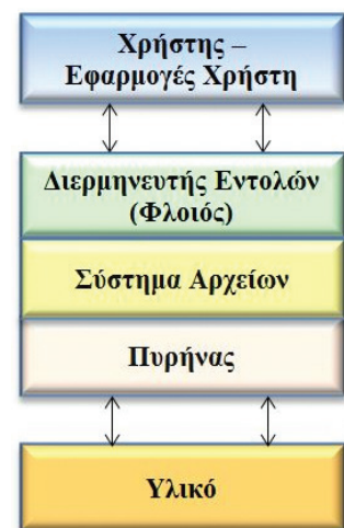
Εικόνα 3.1. Διαστρωμάτωση ενός Λ.Σ.
