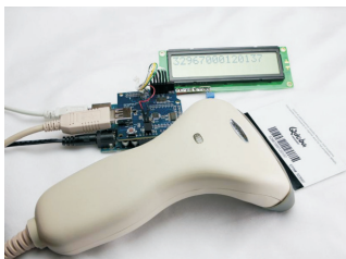
Εικόνα 3.9. Συσκευή γραμμωκώδικα με χρήση πλακέτας Arduino.
