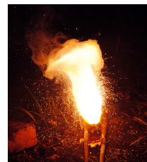
Μία ισχυρά εξώθερμη αντίδραση: Fe_2O_3 + 2Al \rightarrow 2Fe + Al_2O_3
