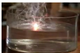
Το κάλιο αντιδρά βίαια με το \text{H}_2\text{O} με ανάφλεξη ελευθερώνοντας αέριο \text{H}_2 .
