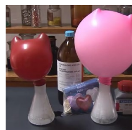
Επίδειξη της αντίδρασης: \text{Zn} + 2\text{HCl} \longrightarrow \text{ZnCl}_2 + \text{H}_2(\text{g}) Το αέριο \text{H}_2 που ελευθερώνεται φουσκώνει το μπαλόνι.
