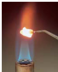
Η αντίδραση σύνθεσης του \text{CaO}(\text{s}) από \text{Ca}(\text{s}) και \text{O}_2(\text{g}) της ατμόσφαιρας.
