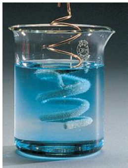
Το σύρμα \text{Cu} αντιδρά με το διάλυμα \text{AgNO}_3 . Το σύρμα \text{Cu} επαργυρώνεται, ενώ το διάλυμα παίρνει μπλε χρώμα που οφείλεται στο σχηματισμό \text{Cu}(\text{NO}_3)_2 .
