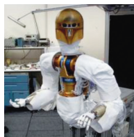
Εικόνα 3.26. Ο «ρομποναύτης» της NASA κατασκευάστηκε για την συντήρηση του διαστημικού τηλεσκοπίου HUBBLE.
