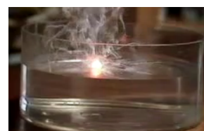
Το κάλιο αντιδρά βίαια με το \text{H}_2\text{O} με ανάφλεξη ελευθερώνοντας αέριο \text{H}_2 .
