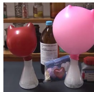
Επίδειξη της αντίδρασης: \text{Zn} + 2\text{HCl} \rightarrow \text{ZnCl}_2 + \text{H}_2(\text{g}) . Το αέριο \text{H}_2 που ελευθερώνεται φουσκώνει το μπαλόνι.
