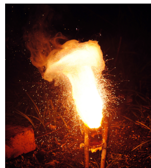
Μία ισχυρά εξώθερμη αντίδραση: \text{Fe}_2\text{O}_3 + 2\text{Al} \rightarrow 2\text{Fe} + \text{Al}_2\text{O}_3
