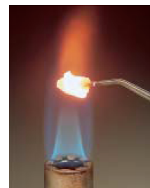
Η αντίδραση σύνθεσης του \text{CaO(s)} από \text{Ca(s)} και \text{O}_2(\text{g}) της ατμόσφαιρας.
