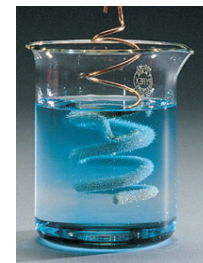
Το σύρμα Cu αντιδρά με το διάλυμα \text{AgNO}_3 . Το σύρμα Cu επαργυρώνεται, ενώ το διάλυμα παίρνει μπλε χρώμα που οφείλεται στο σχηματισμό \text{Cu}(\text{NO}_3)_2 .
