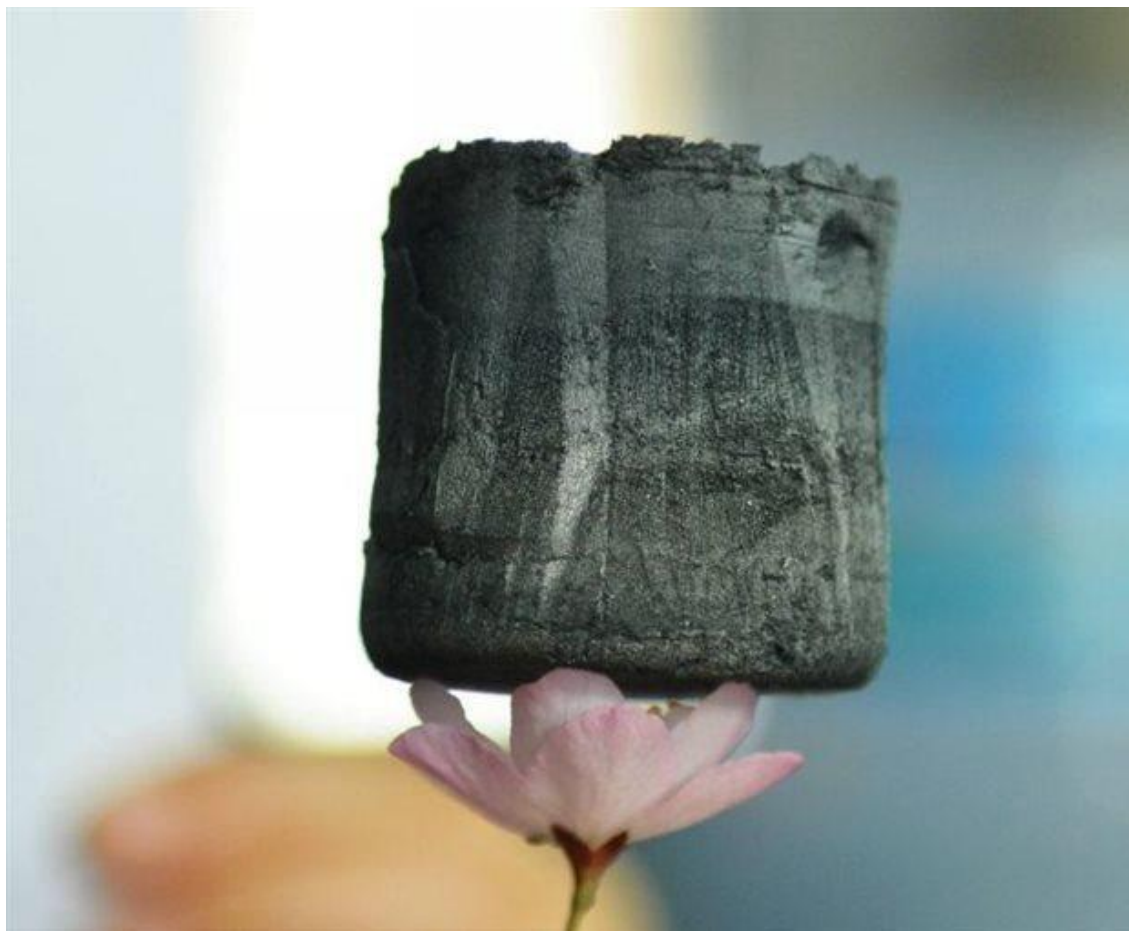
Το «αέρινο» αεροτζέλ που στέκεται ακόμη και πάνω σε ένα λουλούδι είναι φτιαγμένο από γραφένιο
