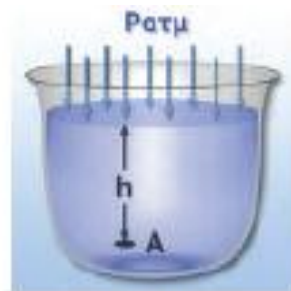
Εικόνα 4.20. Η πίεση στο A δίνεται: p_A = p_{\text{ατμοσφαιρική}} + \rho g h
