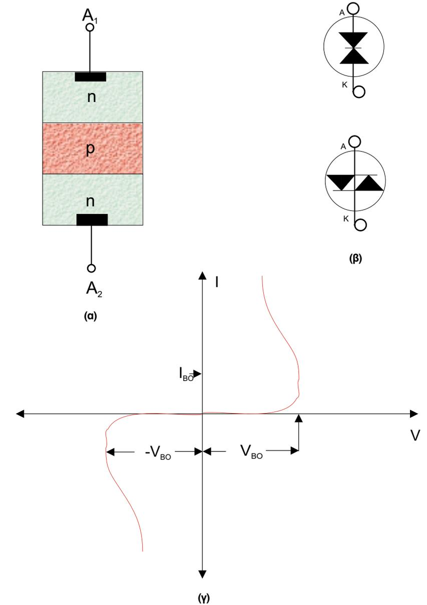
Σχήμα 8.13 α. Δομή β. Σύμβολα γ. Χαρακτηριστική δίοδου DIAC
