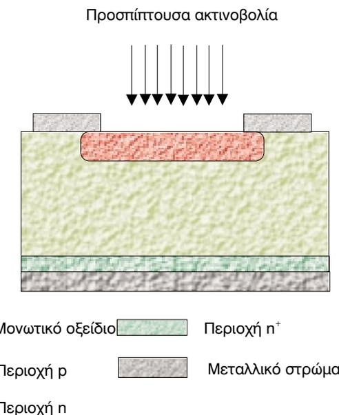
Σχήμα 9.13 Δομή και αρχή λειτουργίας φωτοδίοδου
