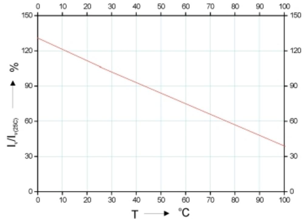
Σχήμα 9.4 Μεταβολή της έντασης ακτινοβολίας με τη θερμοκρασία. Η ένταση εκφράζεται σαν ποσοστό % της τιμής σε θερμοκρασία 25°C.
