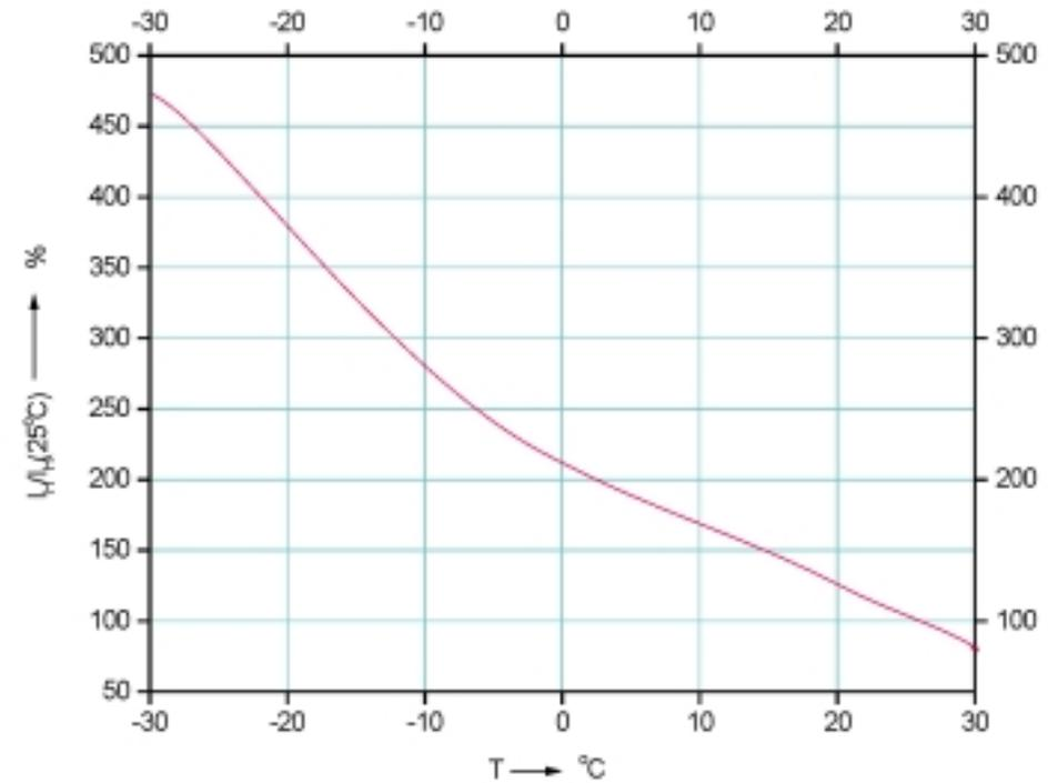
Σχήμα 8.3 Μεταβολή της σχετικής τιμής του ρεύματος συγκράτησης  $I_H$  με τη θερμοκρασία (η σχετική τιμή του  $I_H$  εκφράζεται ως ποσοστό της τιμής που αντιστοιχεί στους 25°C).
