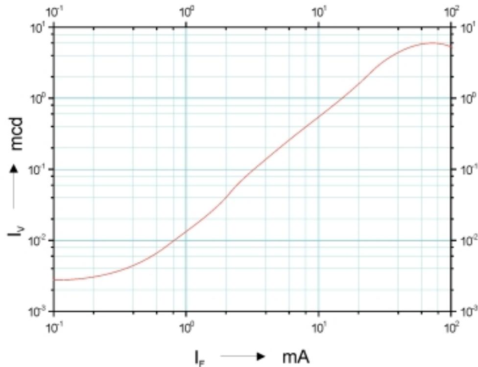
Σχήμα 9.3 Μεταβολή της έντασης ακτινοβολίας  $\sigma$  συνάρτηση με το ρεύμα της LED (μέγιστη τιμή ρεύματος 50 mA) - Μονάδα έντασης 1mcd ( $=10^{-3}cd^1$ ).
