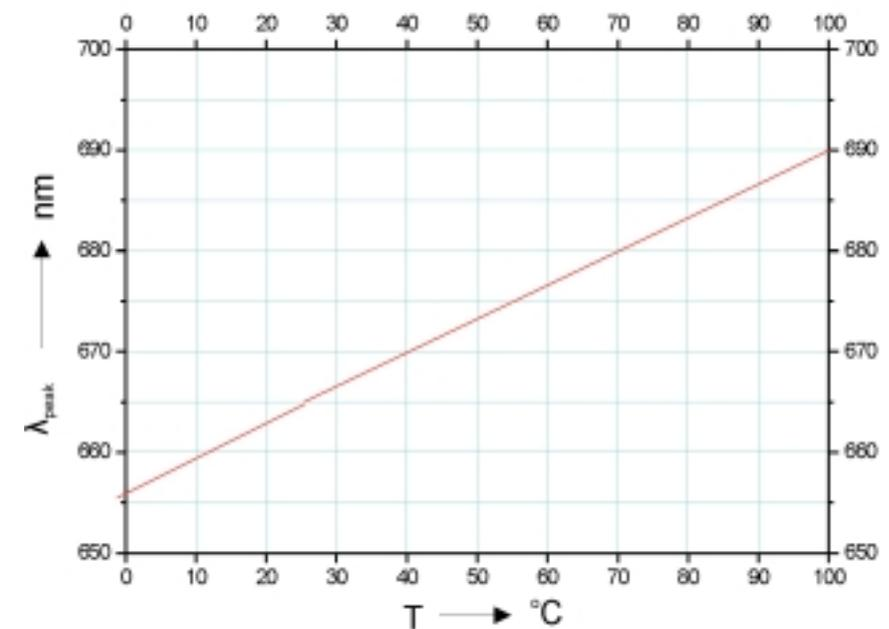
Σχήμα 9.2 Μεταβολή μήκους κύματος μέγιστης ακτινοβολίας  $\lambda_{peak}$  με την θερμοκρασία
