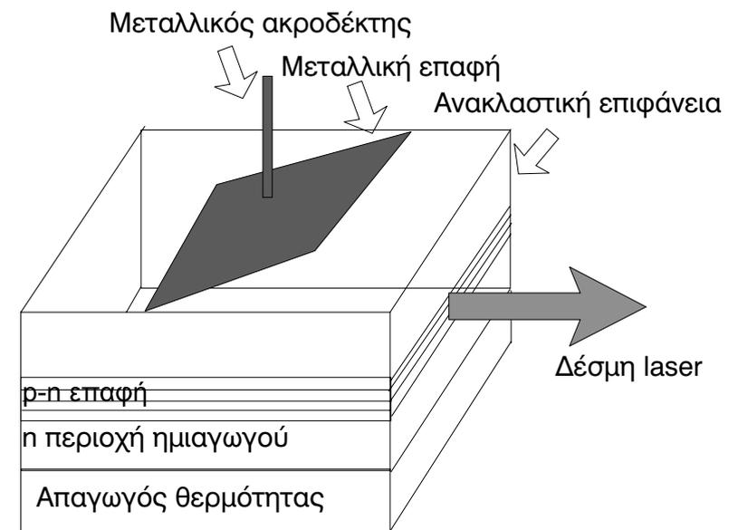
Σχήμα 9.7 Δομή διόδου laser
