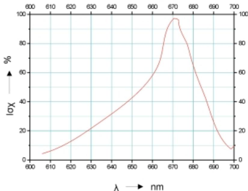
Σχήμα 9.1 Καμπύλη σχετικής φασματικής ευαισθησίας δίοδου LED (υλικό κατασκευής GaAsP-χρώμα φωτός κόκκινο). Η σχετική φασματική ευαισθησία εκφράζεται σαν ποσοστό % της μέγιστης έντασης ακτινοβολίας ενώ το μήκος κύματος λ εκφράζεται σε nm .
