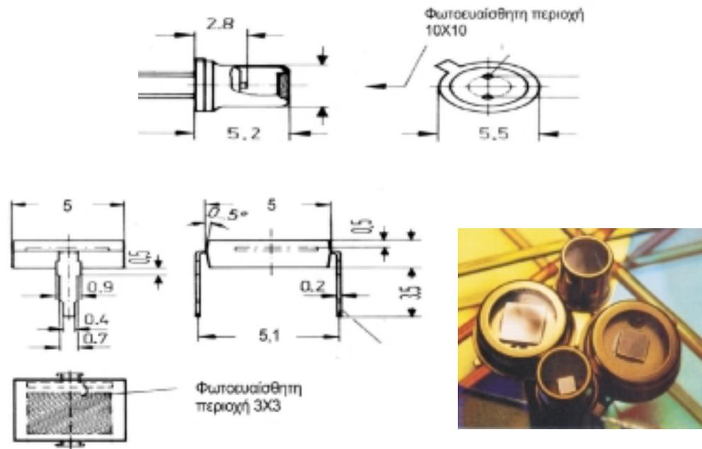
Σχήμα 9.18 Διάφορες μορφές φωτοδιόδων (οι διαστάσεις σε χιλιοστά)
