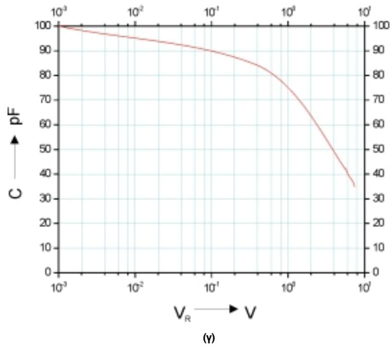
Σχήμα 9.16 α. Μεταβολή τάσης ανοικτού κυκλώματος  $V_L$  και ρεύματος βραχυκύκλωσης  $I_k$  με την ένταση προσπίπτουσας ακτινοβολίας β. Μεταβολή τάσης ανοικτού κυκλώματος με τη θερμοκρασία (σχετική τιμή ως προς την τάση στους 25 °C) γ. Μεταβολή χωρητικότητας σε συνάρτηση με την τάση πόλωσης (όλες οι καμπύλες για φωτοδίοδο πυριτίου)
