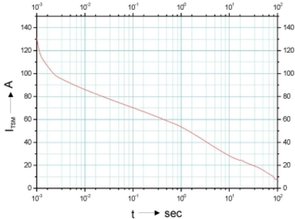
Σχήμα 8.4 Εξάρτηση του  $I_{TSM}$  από τη διάρκεια του παλμού
