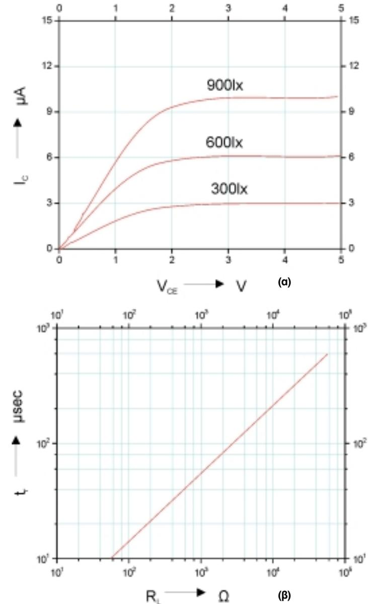
Σχήμα 9.19 α. Σήμηнос χαρακτηριστικών n-p-n φωτοτρανζίστορ πυριτίου β. Μεταβολή χρόνου ανόδου σε συνάρτηση με την αντίσταση φορτίου για n-p-n φωτοτρανζίστορ πυριτίου
