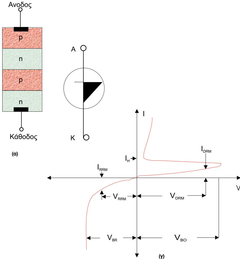
Σχήμα 8.2 (α) Δομή (β) Σύμβολο (γ) Χαρακτηριστική δίοδου τεσσάρων στρωμάτων
