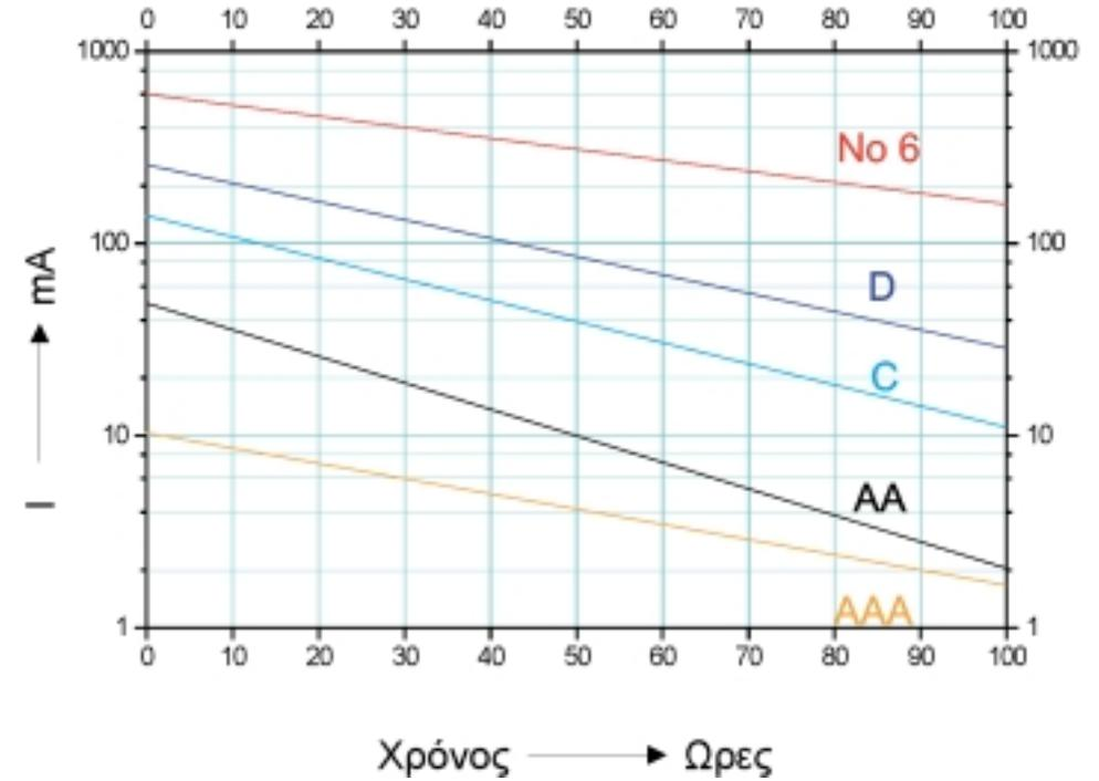
Σχήμα 10.2 Χρόνος ζωής μπαταριών άνθρακα-ψευδαργύρου σε συνάρτηση με το ρεύμα για συνεχή λειτουργία.
