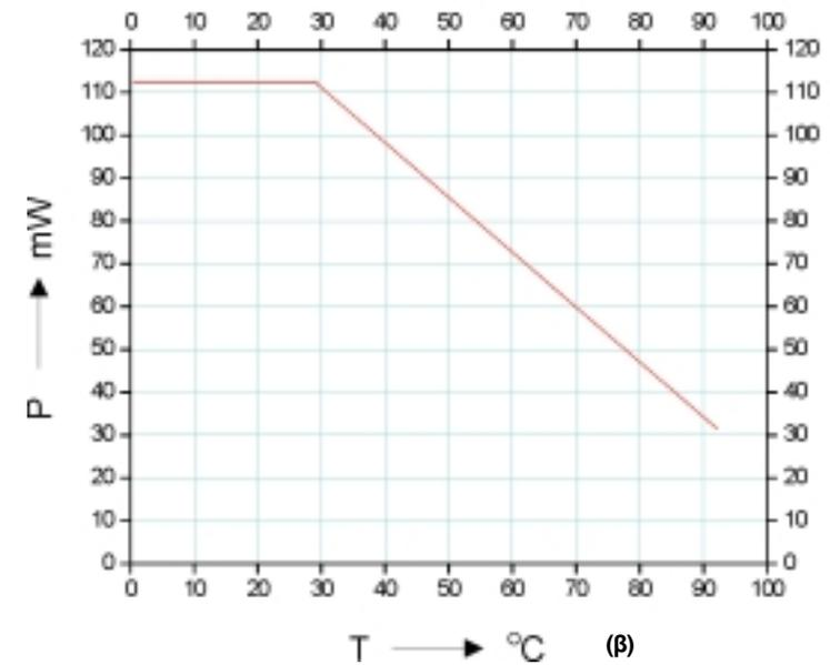
Σχήμα 9.17α. Μεταβολή αντίστασης σειράς με την τάση πόλωσης (συνθήκες σκότους, συχνότητα 100 MHz, φωτοδίοδος p-i-n πυριτίου) β. Μεταβολή ισχύος με τη θερμοκρασία (απλή φωτοδίοδος πυριτίου)
