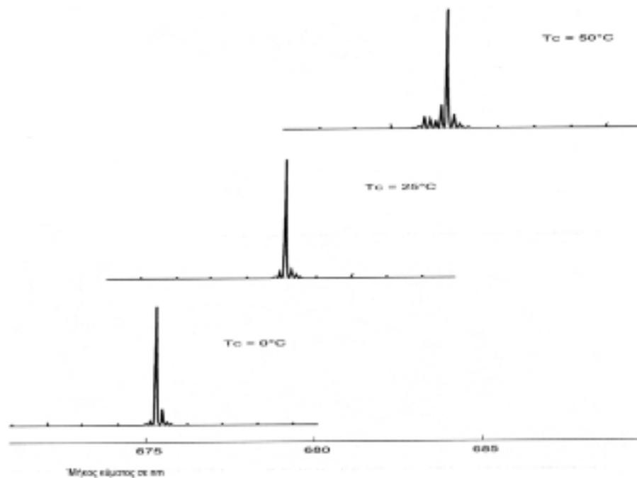
Σχήμα 9.8 Μεταβολή μήκους κύματος με τη θερμοκρασία - καμπύλες φασματικής ευαισθησίας
