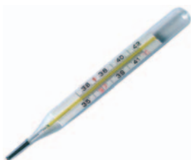
Εικόνα 1.5. Το κοινό κλινικό θερμόμετρο δείχνει αναλογικά τη μεταβολή της θερμοκρασίας
