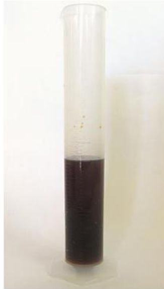
Εικόνα 1. Αφού προσθέσετε τα 30 mL διαλύματος ιωδίου Lugol στον ογκομετρικό κύλινδρο των 500 mL, προσθέστε αρκετό απεσταγμένο νερό ώστε ο συνολικός όγκος του υγρού να φτάσει τα 300 mL.
