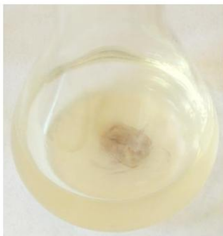
Εικόνα 11. Όταν προσθέτετε μια σταγόνα διαλύματος ιωδίου, μπορεί να δείτε μια προσωρινή αλλαγή χρώματος, όπως φαίνεται εδώ (το σκούρο μπλε στροβιλίζεται), που εξαφανίζεται όταν το διάλυμα ιωδίου αναμιχθεί στη φιάλη περιστρέφοντάς το.
