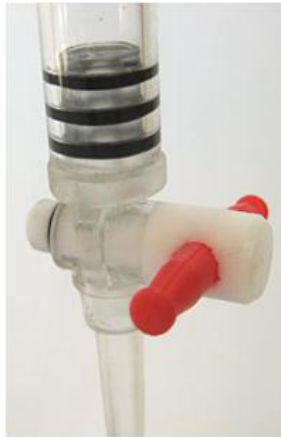
Εικόνα 9. Βεβαιωθείτε ότι η προχοΐδα είναι γυρισμένη στην κλειστή θέση, όπως φαίνεται εδώ με την προχοΐδα από το kit Science Buddies.
