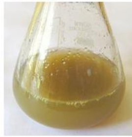
Εικόνα 14. Όταν ολοκληρωθεί η τιτλοδότηση με το δείγμα χυμού πορτοκαλιού, ολόκληρο το δείγμα χυμού πορτοκαλιού θα μετατραπεί από πορτοκαλί σε γκριζοκαφέ χρώμα, όπως φαίνεται εδώ.
