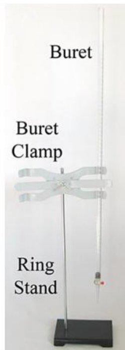
Εικόνα 5. Συναρμολογήστε τη βάση δακτυλίου, τον σφιγκτήρα της προχοΐδας και την προχοΐδα, όπως φαίνεται εδώ.
