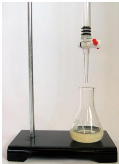
Εικόνα 8. Προσαρμόστε τη θέση της προχοΐδας ώστε να μπορείτε να τοποθετήσετε τη φιάλη Erlenmeyer των 50 mL ακριβώς από κάτω της
