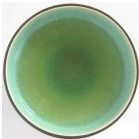
Εικόνα 3. Διαλύστε το κονιοποιημένο δισκίο βιταμίνης C σε 100 mL απεσταγμένο νερό.
