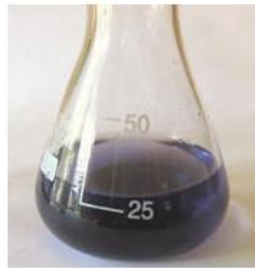
Σχήμα 12. Όταν ολόκληρο το διάλυμα στη φιάλη αλλάξει σε μπλε-μαύρο χρώμα που διαρκεί για περισσότερο από 20 δευτερόλεπτα ενώ το στροβιλίζεται, η τιτλοδότηση έχει ολοκληρωθεί.
