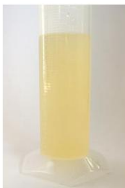
Εικόνα 4. Μεταφέρετε προσεκτικά τα 100 mL διαλυμένης βιταμίνης C στον ογκομετρικό κύλινδρο των 500 mL και γεμίστε τον με απεσταγμένο νερό μέχρι ο συνολικός όγκος να είναι 250 mL.
