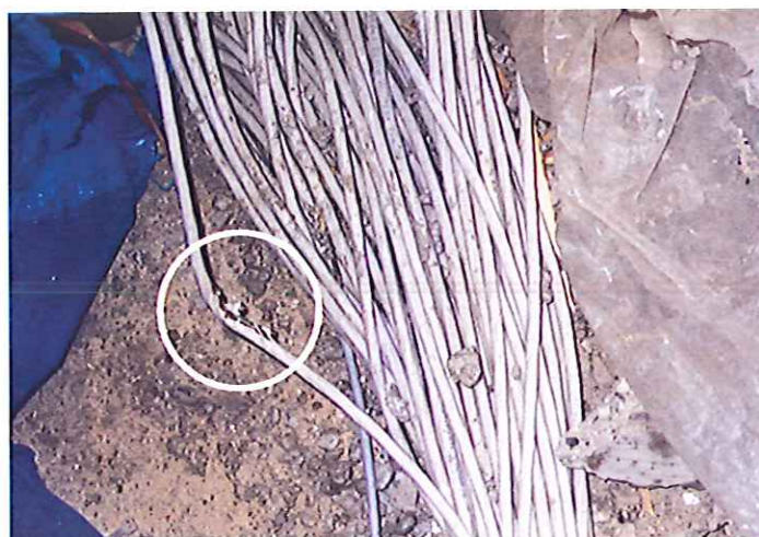
Εικόνα 47 Καλώδιο φαγωμένο από αρουραίο
