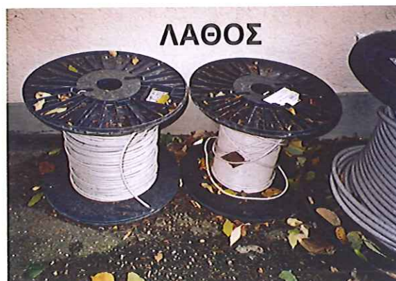
Εικόνα 6 Σωστός και λάθος τρόπος αποθήκευσης καλωδίων
