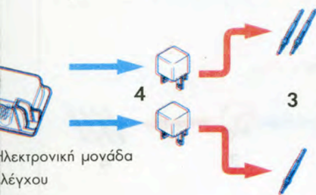
Εικ 6.3.6 Σύστημα ελέγχου πρόσθετης λειτουργίας των προθερμαντήρων ψυκτικού
