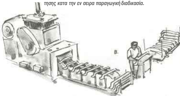
B. Ταινιόδρομος ρύθμισης της τροφοδοσίας
