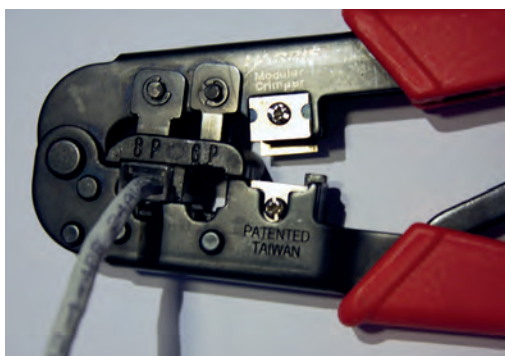
Εικόνα 10: Πρεσάρισμα φισ RJ45
