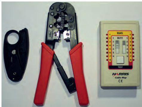
Εικόνα 4: Εργαλεία τερματισμού καλωδίου UTP
