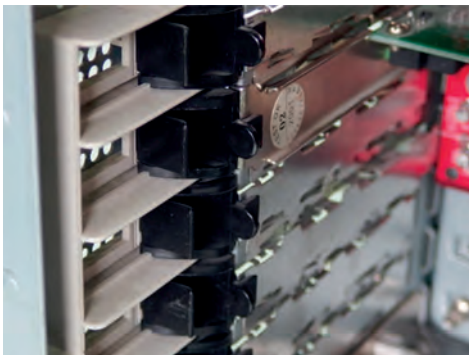
Εικόνα 34. Στερέωση καρτών επέκτασης χωρίς εργαλεία
