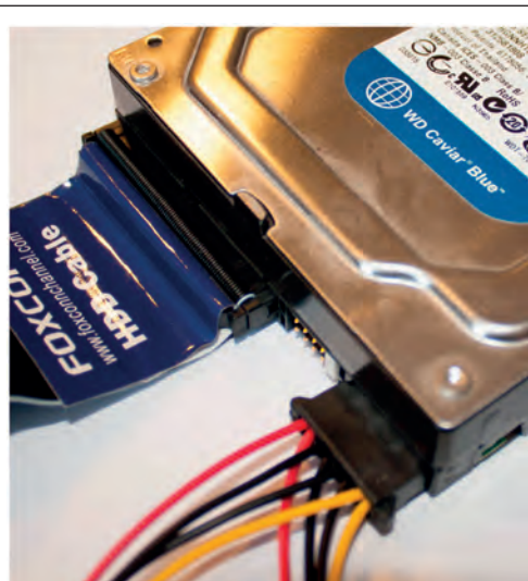
Εικόνα 146: Σύνδεση δίσκου με καλώδιο δεδομένων PATA και ρεύμα με σύνδεσμο τύπου Molex. Ενδιάμεσα διακρίνονται οι διακόπτες γέφυρας για τον ορισμό του δίσκου ως κύριου ή δευτερεύοντος
