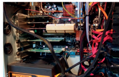
Εικόνα 53. Θήκη με σχεδίαση για τοποθέτηση του τροφοδοτικού στο κάτω μέρος
