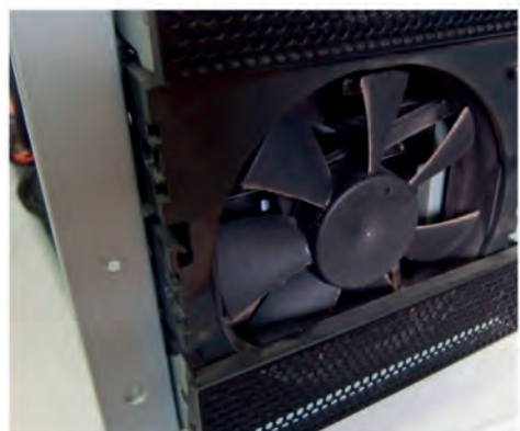
Εικόνα 52. Ανεμιστήρας πρόσοψης της θήκης της ΚΜ
