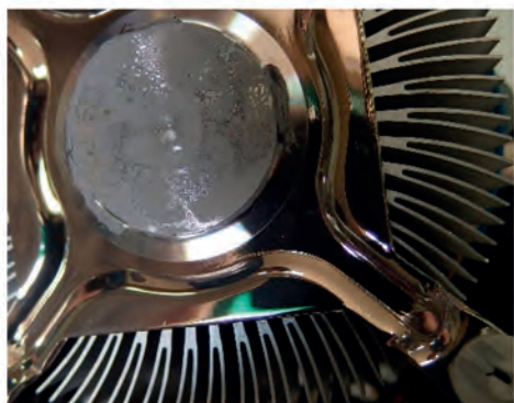
Εικόνα 65. Κατάλοιπα θερμοαγωγίμης κόλλας
