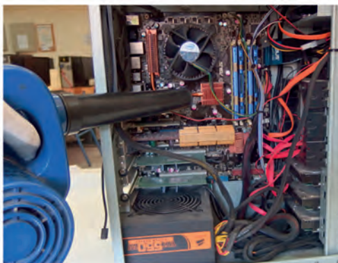
Εικόνα 68.Καθαρισμός με ηλεκτρικό φουσητήρα
