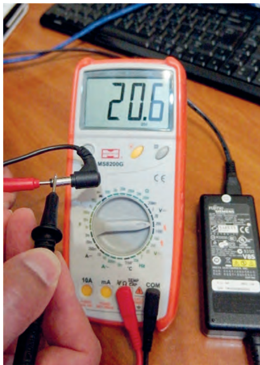
Εικόνα 196. Μέτρηση τροφοδοτικού με πολύμετρο
