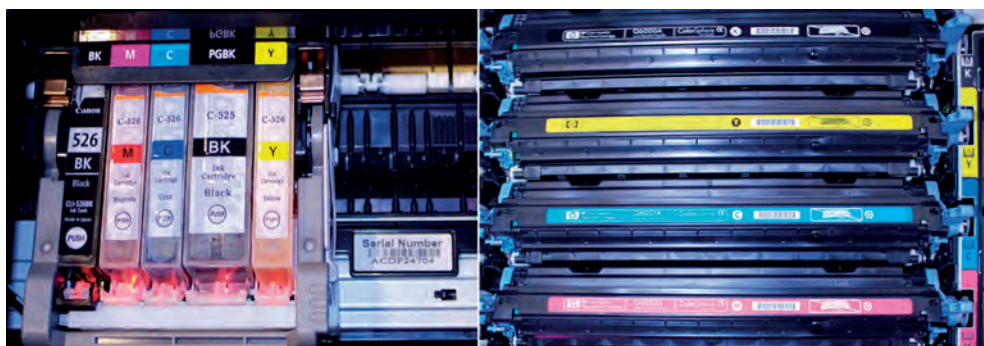
Εικόνα 242 Δοχεία μελάνης (αριστερά) και γραφίτη (δεξιά)
