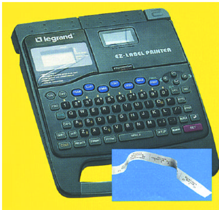
Σχήμα 6.6: Ηλεκτρονικό πληκτρολόγιο τίτλων για την τακτοποίηση κυκλωμάτων.
