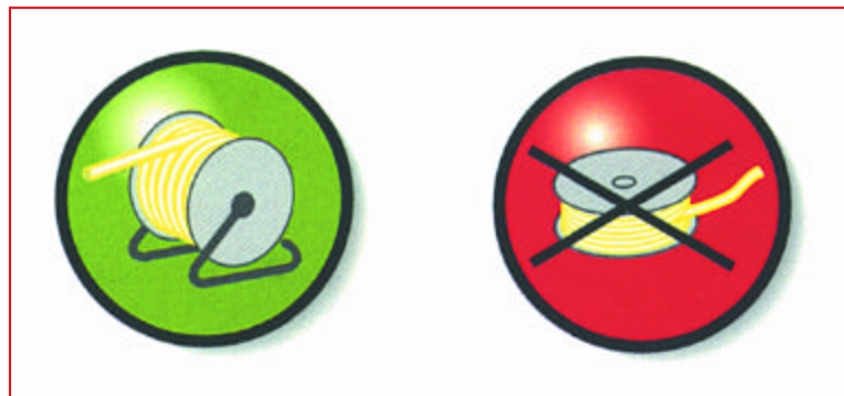
Σχήμα 6.2: Σωστό και λανθασμένο ξετύλιγμα καλωδίων.
