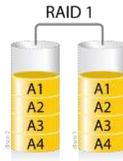
Εικόνα 3.2. Συστοιχία RAID 1 (mirroring).
