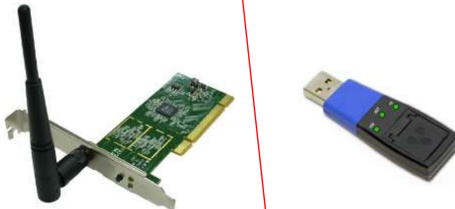
Εικόνα 9.3: Δύο μορφές καρτών Δικτύων: Κάρτα επέκτασης PCI (αριστερά) και USB Stick (δεξιά)
